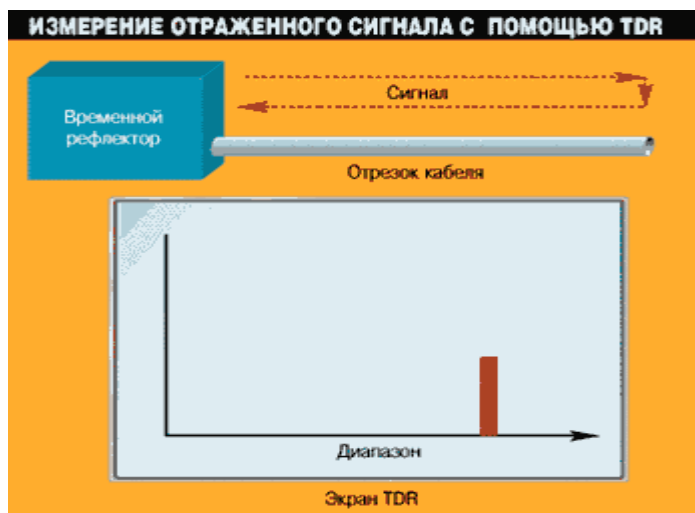
Рисунок 14 - Временной рефлектор замеряет изменения в импедансе в отрезке кабеля. На основании этих изменений он способен установить соответствие длины канала требованиям стандарта.
